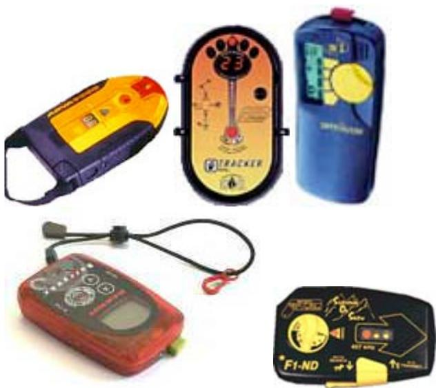
L'ARVA est un appareil de recherche de victime d'avalanche. Il en existe de différentes marques mais tous ont un point commun: la fréquence d'émission normalisée actuelle est de 457 kHz. Certains modèles plus anciens sont bi-fréquences : ils émettent et reçoivent sur deux fréquences : l'ancienne norme 2275 kHz, et la nouvelle 457 KHz. N'utilisez plus d'ARVA émettant seulement sur l'ancienne fréquence !
